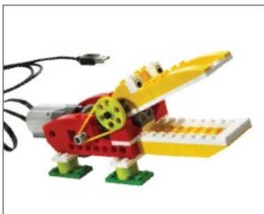
Coodril realitzat amb mecanismes per a obrir i tancar la boca. Fet amb peces de LEGO WeDo.
